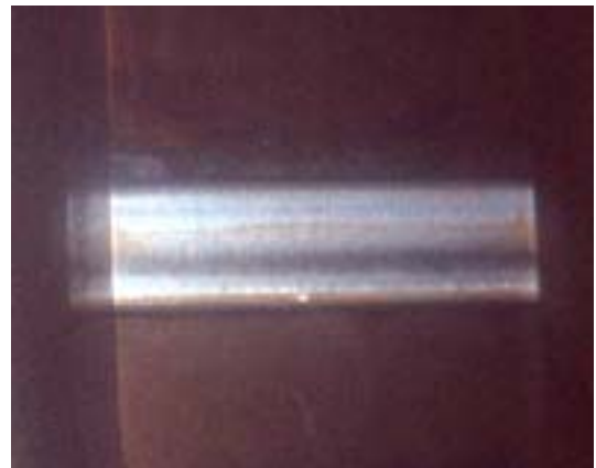
図4 油の付着状況の画像例 (TOP リング, 85%負荷, 上昇行程)
