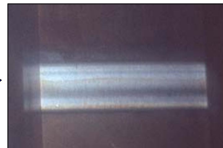
ピストンリング表面の油膜の観察可能
