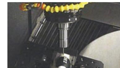
計測と機械加工の融合による適応加工
