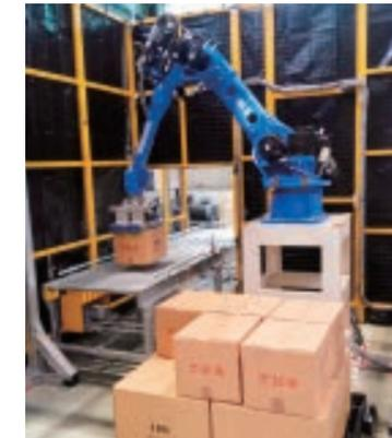
AI搭載デパレタイズロボットシステム
