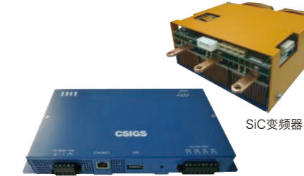
控制系统安装平台
