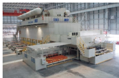
采用V型送料器的大型串联冲压线
