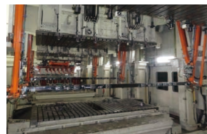
冲压机之间面板高速搬运装置（V型送料器）
