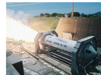
SRB-A 地面燃烧试验 (提供: JAXA)
