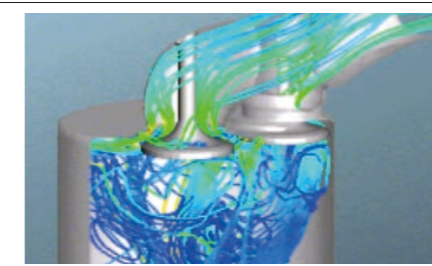
发动机汽缸内部流量分析
