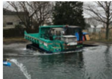
半水中遠隔操作型重運搬ロボット(UGS)
