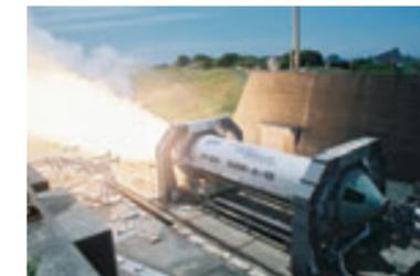
SRB-A地上燃焼試験 (提供:JAXA)
