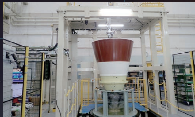
非接触超音波探傷検査装置
