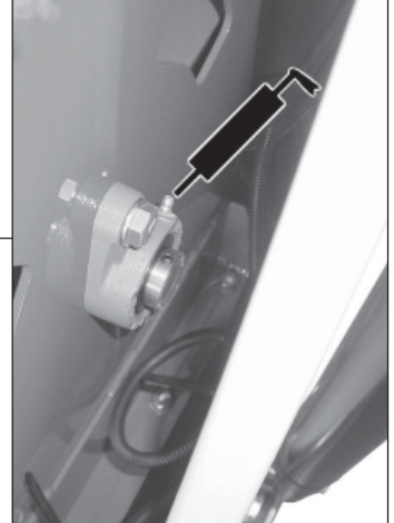
送風機ピローブロック(右)
