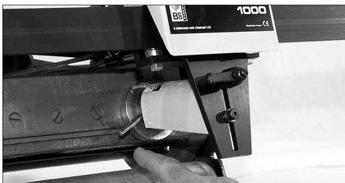
（使用に伴って砥石が磨耗してくると、ディスクとフィンガーとのすきまが大きくなってきます。このすきまがなるべく小さくなるように、ウイング・ノブ（パーツ図64）をゆるめてサイド・ガード（パーツ図60）を調整し、フィンガー・アセンブリを後退させてください。）
