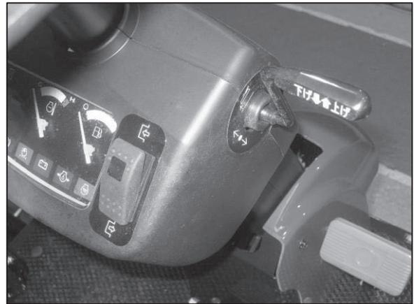
レバーを上に出ると作業機が上昇し、下に下げると作業機が下降します。
