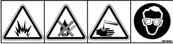
バッテリーからは爆発性のガスが発生しますので火気厳禁です。バッテリー液には硫酸が入っています。眼鏡を使用し衣服も保護してください。
