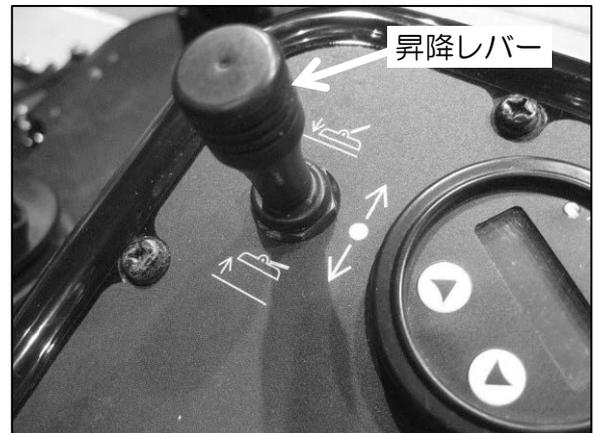
作業機を昇降するときに使用します。手前に引くと作業機が上昇し、奥に倒すと作業機が下降します。
