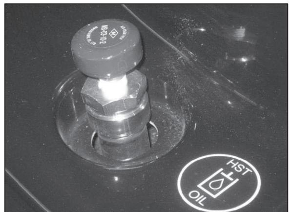
ブリーザを反時計方向に回すとブリーザは外れます。給油後、ブリーザを締め込んでください。
