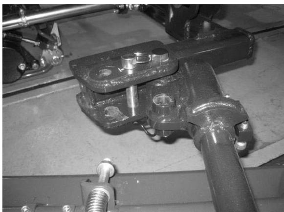
ユニットを横に引き出したら、(1)で外した固定ピンを写真の位置差し込みます。ユニット上昇時の戻り防止のため必ず固定ピンを差し込んでください。
