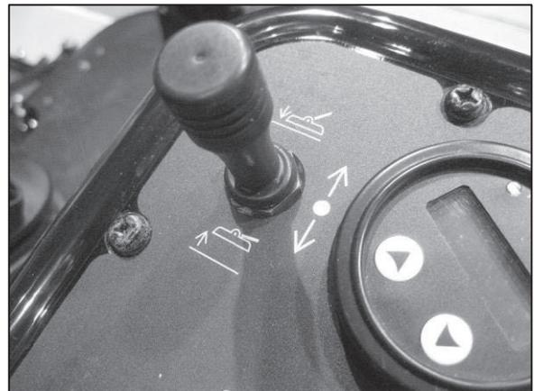
手前に引くと作業機が上昇し、奥に倒すと作業機が下降します。
