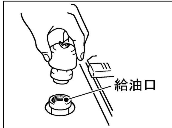
後カバー、前カバーを開けます。油圧タンク上部のフタを固定しているボルトをゆるめるとフタが外れます。給油後、元通り締め付けてください。
