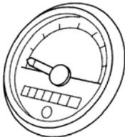
回転中はエンジン回転を指針で示します。積算時間計は、機械の使用時間を数字で示します。右端の白文字の数値を6倍すると『分』単位の時間になります。
