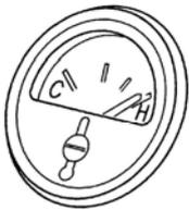
運転中の冷却水温度を指針で示します。針が「H」位置を示した場合は、エンジンがオーバーヒートのおそれがあります。エンジン水温計のランプが点灯しなくても作業を中断して点検してください。
