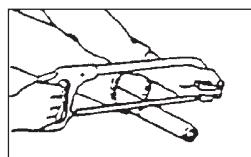
切断するときは、パイプの中にウエスを詰め、パイプの内面に切り粉が付着するのを防いでください。
