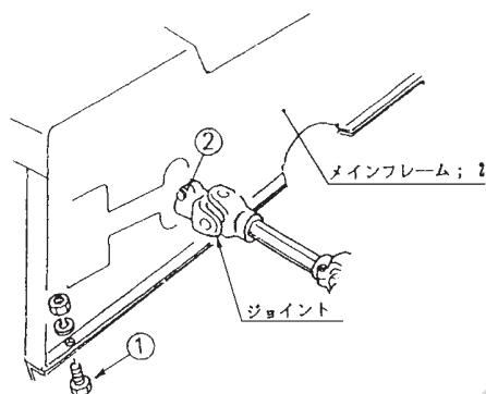
(4) フレーム後方のボトムプレートとダクトをとめているカクネボルトをはずします。
