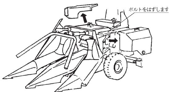
(3) メインフレーム；2の取付けボルト①（両側）およびボルト②をゆるめ、リヤロール駆動のジョイントをはずします。
