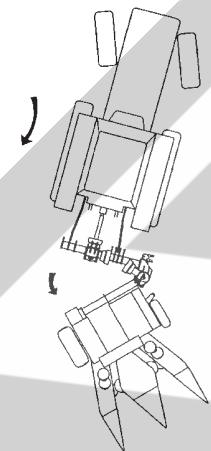
(3) 本体と3点フレームが90°開いたら、トラクタの外部油圧を旋回用シリンダが伸びる方向に操作しながら、サイド状態になるまでバックします。
