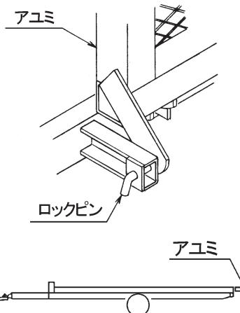
(6) ボディの後方に乗り、ボディを傾斜させます。
