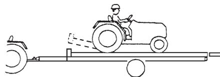
(12) 完全に水平になったら、10~20cmドロワー側に移動し停止してください。
