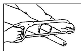
(4) 切り口をヤスリなどでなめらかに仕上げしてからパイプをよく清掃し、次にグリースを塗布して、アウタとインナを組み合せてみます。
