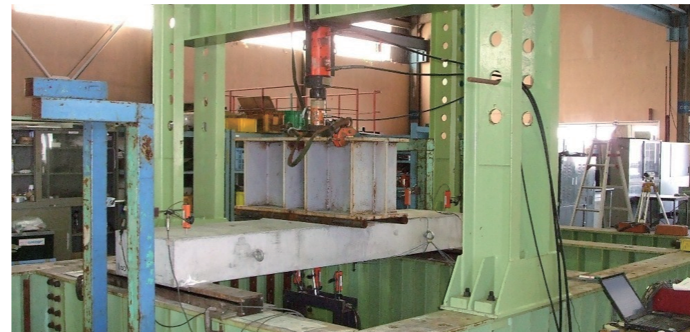
DEW パネルを用いた壁高欄の静的曲げ試験
