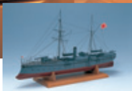
民間造船所で建造された最初の鉄骨・鉄皮軍艦「鳥海」
