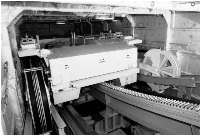
第2図 100 t マス型ハイブリッド式船用減揺装置 Fig. 2 Hybrid anti-rolling system with 100t mass weight
