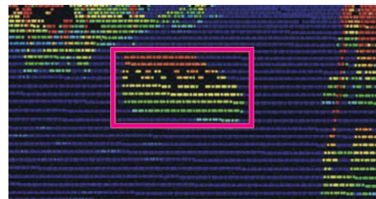
踏切内状況(カメラ映像に赤枠で検出結果を表示)
