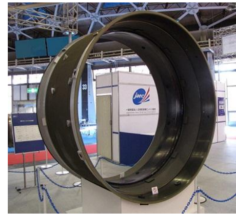
IHIエアロスペース富岡事業所で製造を行う「PW1100G-JM」のファンケース 提供：一般財団法人日本航空機エンジン協会(JAEC)
