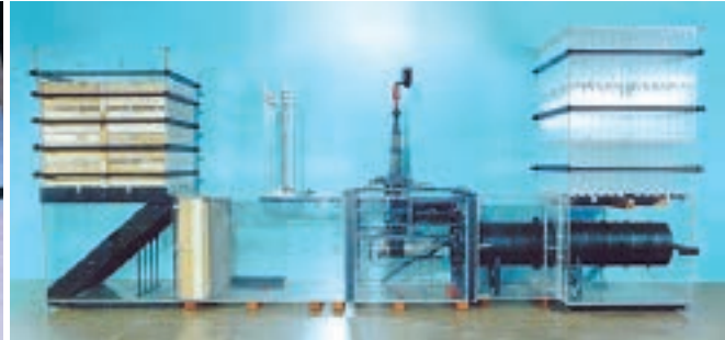
エンジンテストセルの空力・音響模型試験
