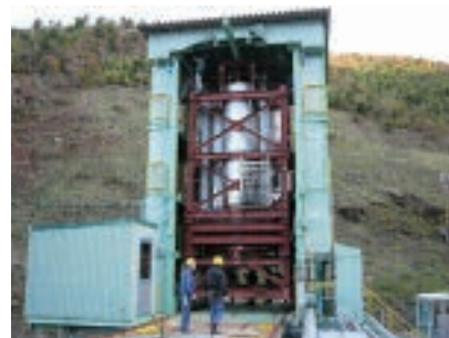
LOX/LNGエンジン燃焼試験設備
