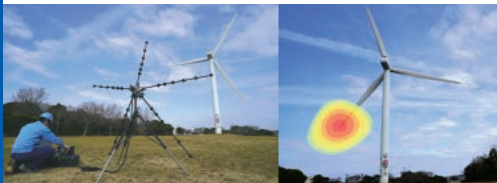
音響カメラによる計測
