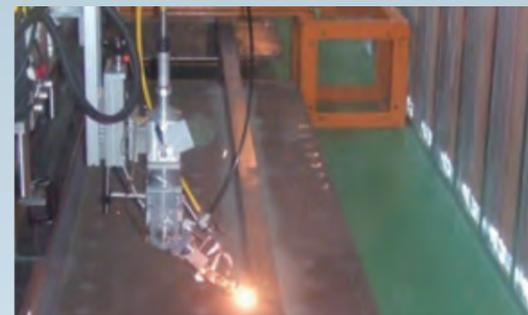
高精度で高速、しかも入熱量が少なく歪みの少ない施工が実現出来るレーザー溶接技術を橋梁部材の製作に適用する研究を進めています。継手試験等でその性能を確認し、一部は実構造物への試験適用も行いました。
