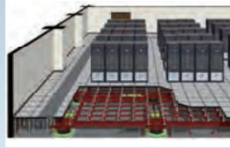
免震床は大地震に対して水平・鉛直方向に機能を発揮し、損害を最小限に止める装置です。建物内に設置することでコンピュータ等の重要機器を地震から守ります。
