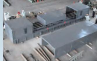
海上クレーンの吊り枠に装備する制振装置です。強風や波浪による吊り枠の揺れを低減し、吊り荷の玉掛け作業の安全性の向上に役立ちます。
