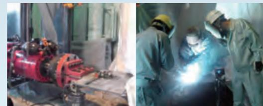
今後ますますニーズが高まると予想される社会インフラの補修・補強技術の一環として、道路供用下での鋼床版補修工事を想定して鋼床版に生じる振動をアクチュエータで再現し、溶接欠陥を生じにくい溶接材料と溶接条件の検討を進めています。
