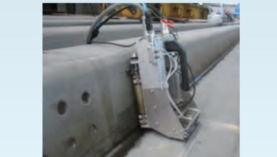
道路橋示方書ではデッキプレートとUリブの縦方向溶接はUリブ板厚の75%の溶け込みが要求されています。弊社では、Uリブ溶接の溶け込み量計測に関する独自の検証方法を確立し、検査機器の開発を行っています。
