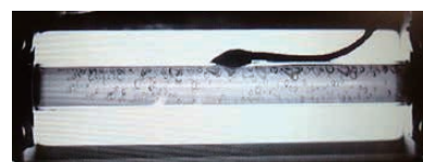
沸騰・二相流の透明伝熱管内の様子
