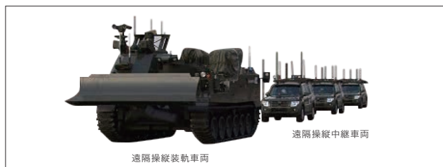
CBRN対応遠隔操縦作業車両システム
