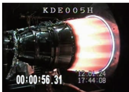
ダウンサイズエンジン(真空燃焼試験)
