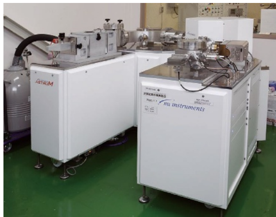
Nu Instruments LTD ASTRUM グロー放電質量分析装置(微量元素分析装置)
