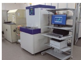
Rigaku Simultix15 蛍光X線分析装置
