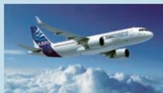
AIRBUS社A320neo型機に搭載。米Pratt&Whitney社、日本航空機エンジン協会、独MTU社により共同開発され、ギアードターボファンシステムを採用したエンジンです。
