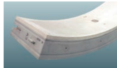
コンクリート打設後
