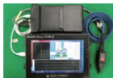
渦電流を利用し、塗膜を剥がさずに表面のき裂の検出が可能です。
