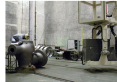
マイクロフォーカスを使った精密検査から高出力X線を使った厚肉検査まで幅広いRT検査ができます。また、用途に応じてデジタルラジオグラフィを使った検査もできます。
