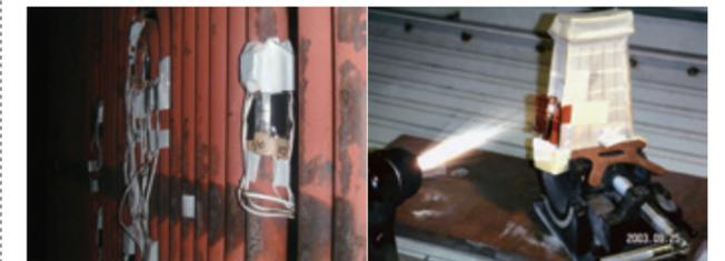
プラント配管の高温ひずみ計測
