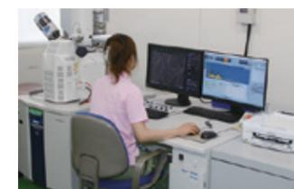
FE-SEM (最大試料サイズφ200x80(H)mm)
