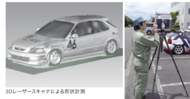
3Dレーザースキャナによる形状計測
