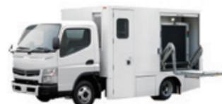
車載式X線検査装置
