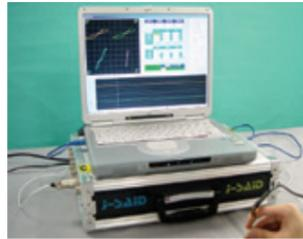
渦電流を利用し、自動車部品や航空機部品などの金属表面に存在する微細なきずの検出が可能です。また、非接触探傷が可能のため、後処理などを必要としない検査手法です。各種プラントの機器、部品へ幅広く適用できます。
