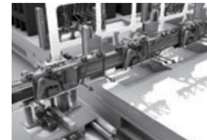
プレス間搬送装置レトロフィット
