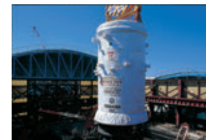
原子炉圧力容器 写真提供:東京電力ホールディングス株式会社
