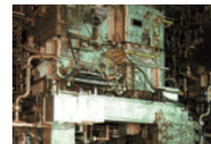
高レベル廃液ガラス固化設備 写真提供:日本原燃株式会社
