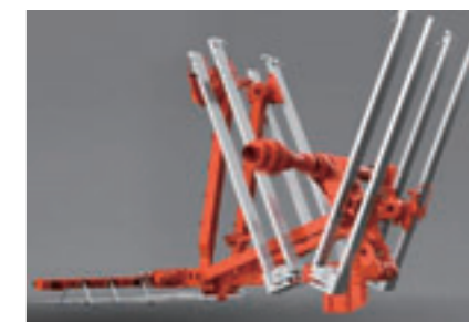
プレス間搬送装置「X-Feeder」
