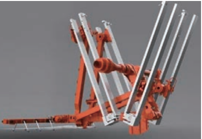
冲压车间传送装置(X-Feeder)
