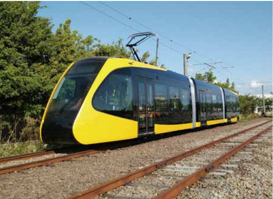
宇都宮ライトレール 超低床式路面電車 HU300形 ライトライン
