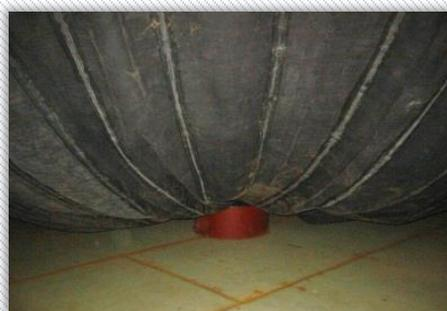
経年劣化でゴムが硬化し、亀裂が発生するケースがあります。
