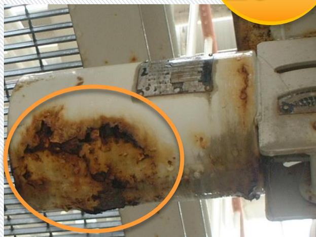
発錆によるケースの破損(ばねが飛び出すケースあり)
