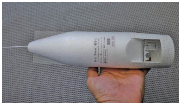
（注）右端の温度と湿度センサー側が下になって落下し、上空から海面までの温度、湿度、気圧、風向・風速、高度を測定する。ボディは生分解性素材でできている。
