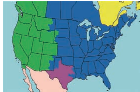
第1図 北アメリカの電力系統 (1) Fig. 1 North American power grid (1)
