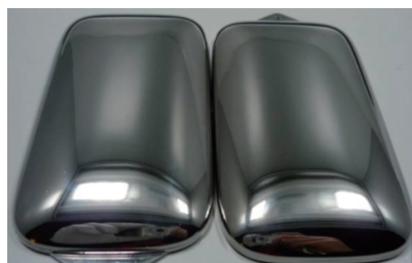
CASS 試験の結果。腐食は見られない
