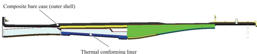
Fig. 7 Composite fan case cross-section
