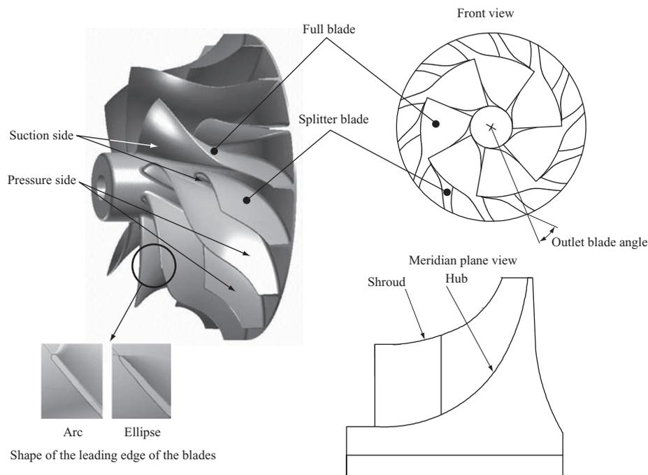
Fig. 4 Centrifugal compressor impeller
