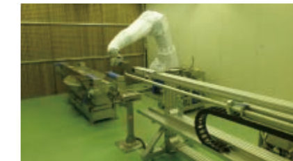
喷漆工艺的机器人化及高效率化
