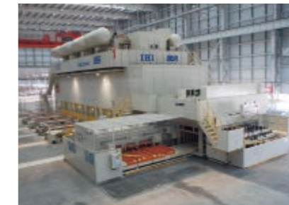
采用V型进料器的大型串联冲压线
