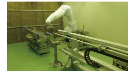
喷漆工艺的机器人化及高效率化
