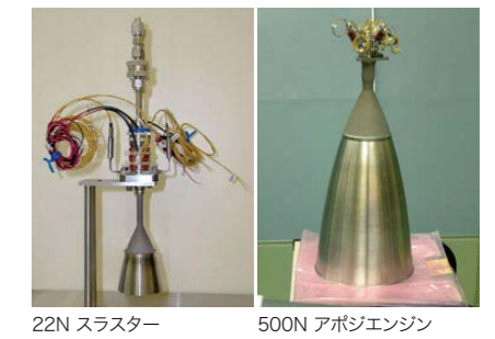
22N スラスター 500N アポジエンジン 静止軌道投入用2液アポジエンジン等の開発
