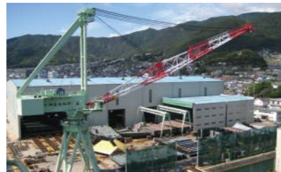
ジブクレーン
