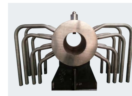
A-USCボイラ実機適用に向けたモックアップ製作
