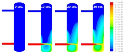
熱量変動シミュレーション例
