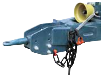
11/13m³クラスは ヒッチ高さ調整機能付き。
