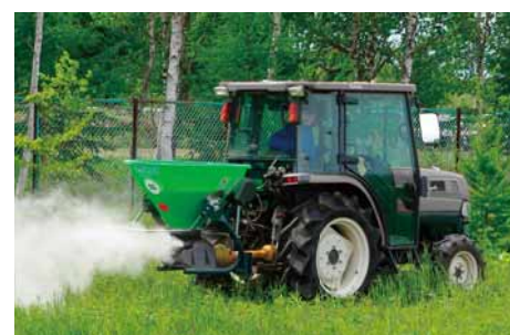
■肥料残量が見える!半透明ホッパ (400ℓタイプを除く)
