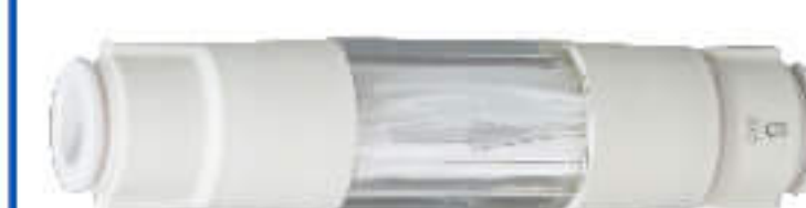
ニューハイミニアフィルター ろ過精度0.01 \mu mの中空糸膜 により、気体中の微粒子、菌を 除去します。
