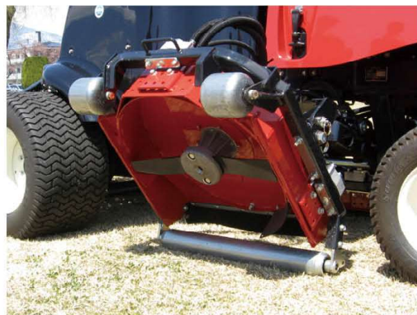
フリップアップ機構 刃の状態が確認できて、メンテナンス性が良い
