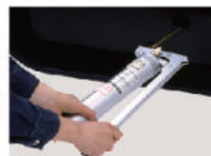
▲ゴムクローラの張り調整
