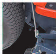
詰まり解消レバー② (トラクタ中央下部)
