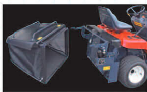
トラクタと集草ホッパーの 取り外しが容易
