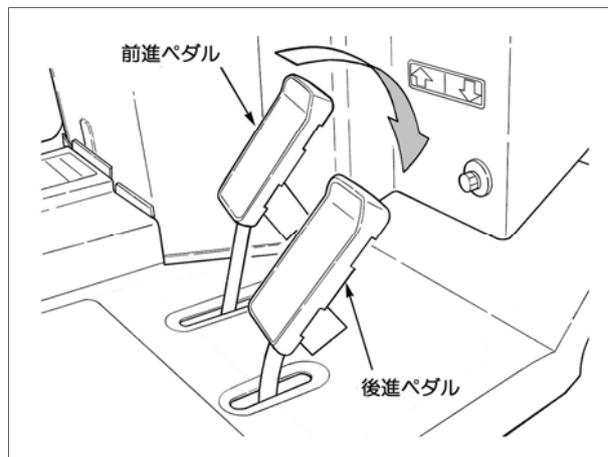
本機を前進させるには前進ペダル、後進させるには後進ペダルを踏みます。この機械にはクラッチペダルはなく、ペダルの踏み具合（強弱）により速度を上げたり下げたりできます。走行ペダルの踏み具合で発進時の速度が違いますので、発進時にゆっくり踏み込んでください。平坦地において、ペダルから足を離すと、ペダルは自動的に中立位置に戻り車輛は停止します。
