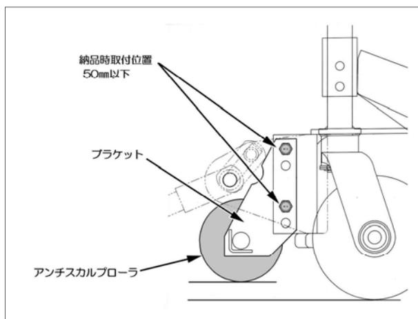
刈り高さが34mm～42mmに設定する場合は、ブラケットの上側の穴とモアデッキの上側の穴で付属のボルト・ナットで固定してください。（納品時取り付け位置）
