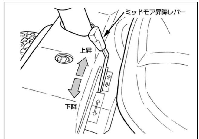
ミッドモアを上下させるには、昇降レバーを前方後方に倒すとモアは下降して、後方に倒すとモアは上昇します。上昇・下降後レバーから手を離すと自動的に中立位置に戻ります。ミッドモアを下降する場合は昇降レバーを前方に倒し、1～2秒間保持してください。(リフトチェーンがたるむまで)
