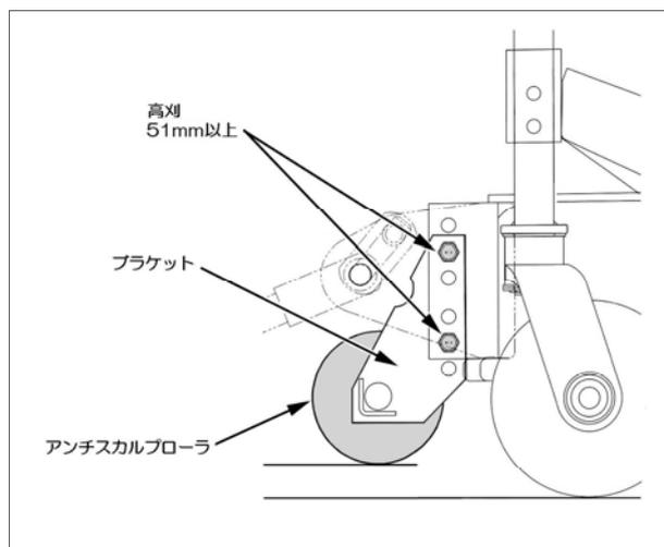
刈り高さを51mm以上に設定する場合は、ブラケットの上側の穴と、モアデッキの下側の穴で付属のボルト・ナットで固定してください。
