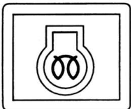
メインスイッチを「ON」位置にすると、ランプが点灯してヒータに通電したことを示します。メインスイッチを「START」位置に回し、エンジンを始動します。
