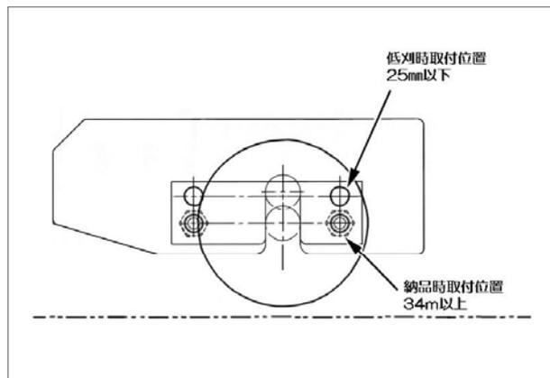
刈り高さが34mm以上の場合は、ブラケットを下側の位置で固定してください。(納品時の取り付け位置)
