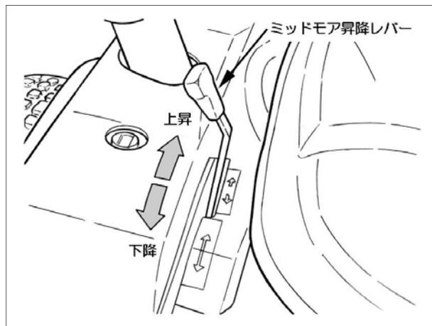
レバーを後方に倒すと上昇し、前方に倒せば下降します。レバーから手を離すと自動的に中立位置に戻ります。ミッドモアを下降する場合は、昇降レバーを前方に1秒間保持してください。(リフトチェーンがたるむまで)
