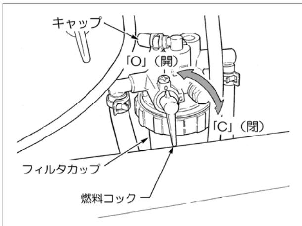
この機械の燃料フィードポンプは、カムシャフトからの駆動で作動していますので清掃・交換などの作業をした後のフィルタカップ内のエア抜きは、キャップを外しエア抜きを行なってください。
