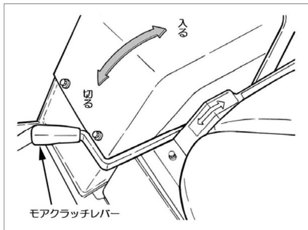
モアクラッチレバーを「入」にすると刈刃が回転します。「切」にするとクラッチが切れ刈刃の回転が停止します。
