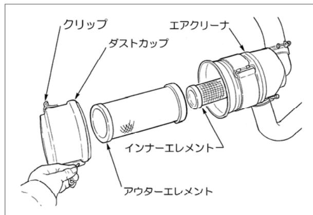
アウターエレメントは100時間毎に清掃、6回掃除の後には交換してください。ホコリの多い所で作業するときは、もう少し短い間隔で掃除してください。規定時間になっていなくても1年間で要素を交換してください。
