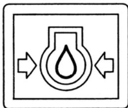
メインスイッチを「ON」位置にするとランプが点灯し、エンジンが始動するとランプは消えます。エンジンが回転中にランプが点灯するときは、潤滑圧力回路に異常が発生したからです。すぐにエンジンを停止して点検してください。
