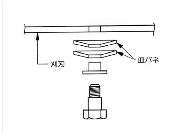
上図のように取り付けてください。皿バネの方向に注意してください。(凹部を刈刃側にする)
