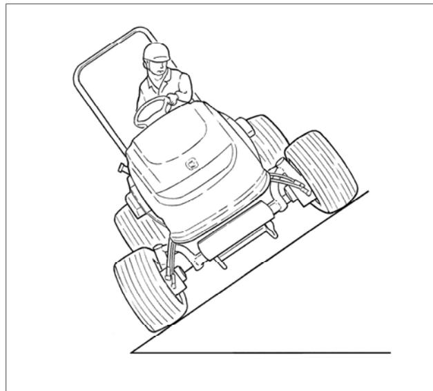
オイルタンク上部のシートスイングレバーを握ると、シートが左右に  $12.5^\circ$  と  $25^\circ$  の2段階にローリングします。等高線の連続作業時に使用することにより、楽な姿勢で安全な作業が行なえます。
