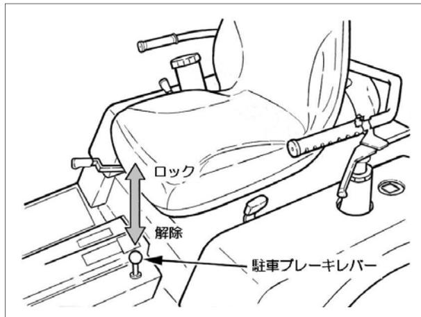
ブレーキペダルをいっばいに踏み込み、レバーを引き上げると駐車ブレーキが働きます。解除するときは、ブレーキペダルを踏み込み、レバーを押し下げながらブレーキペダルを離すと解除されます。
