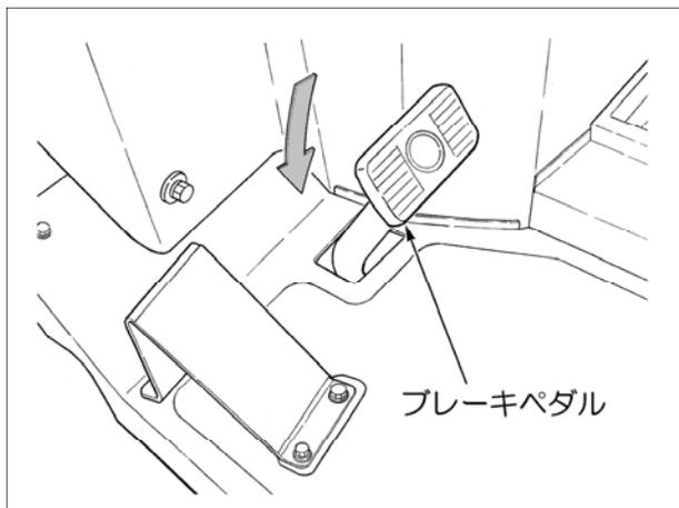
ブレーキペダルを踏むことでブレーキがかかります。また、始動安全装置が付いているので、始動時には必ず踏んでください。
