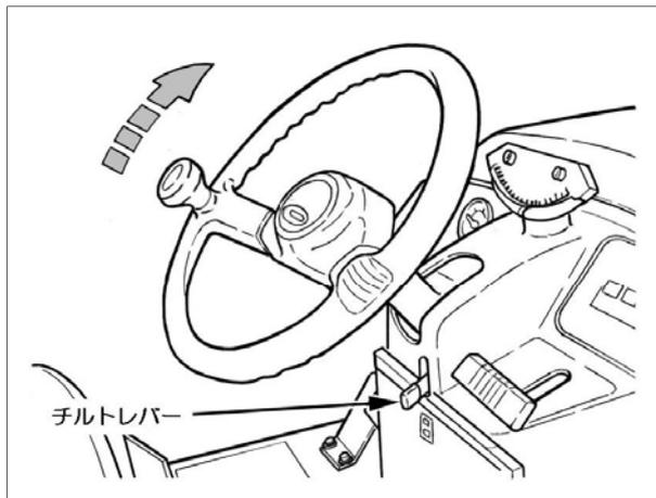
ハンドル角度を調整できます。チルトレバーを引くとハンドル位置を自由に調節できます。位置が決まったらチルトレバーを前方にして固定してください。また、走行中での調節は行なわないでください。
