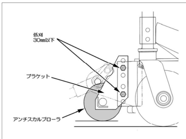
刈り高さを25mm以下に設定する場合は、ブラケット下側の穴と、モアデッキの上側の穴で付属のボルト・ナットで固定してください。
