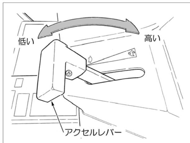
エンジン回転を速くしたり、遅くしたりするのに使います。レバーを手前へ引くと、エンジン回転が低くなります。レバーを前へ押し、エンジン回転が高くなります。
