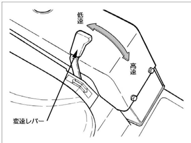
本機の车速を作業内容に合わせて「L」低速（4 駆）・「H」高速（2 駆）の2通りに選ぶことができます。前側に倒すと高速に、後側に倒すと低速になります。通常の作業では低速側にしておき、高速側を使用するのは移動するときだけ使用してください。変速するときは本機を停止させてから行ってください。
