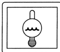
メインスイッチを「ON」位置にしてもランプは点灯しません。運転作業中にエンジンがオーバーヒートすると点灯します。作業を中断して点検してください。
