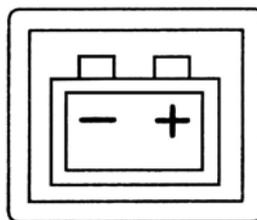
メインスイッチ「ON」位置にするとランプが点灯します。エンジン始動後、エンジン回転が上がり充電し始めるとランプは消えます。
