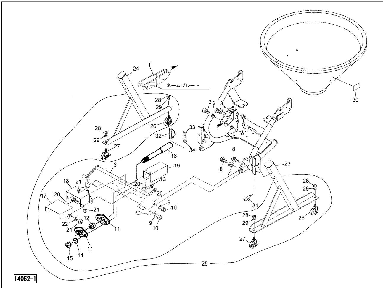
d. ⑥ロワーリンク C Pを本機に取り付けてください。まず、⑯P I C シャフトに通し、⑧ボルト；M 1 2 × 4 5、⑨バネザガネM 1 2、⑩ナットM 1 2で仮止めしてください。
