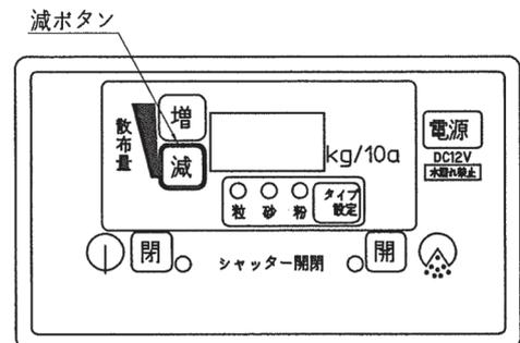
(3) コントロールボックスの「閉」ボタンを押し続けて、落下口の穴が閉まっていることを確認してください。
