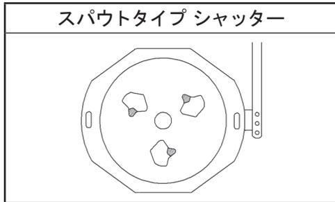
(4) コントロールボックスの「開」ボタンを押し続けて、落下口の穴が全開になっていることを確認してください。
